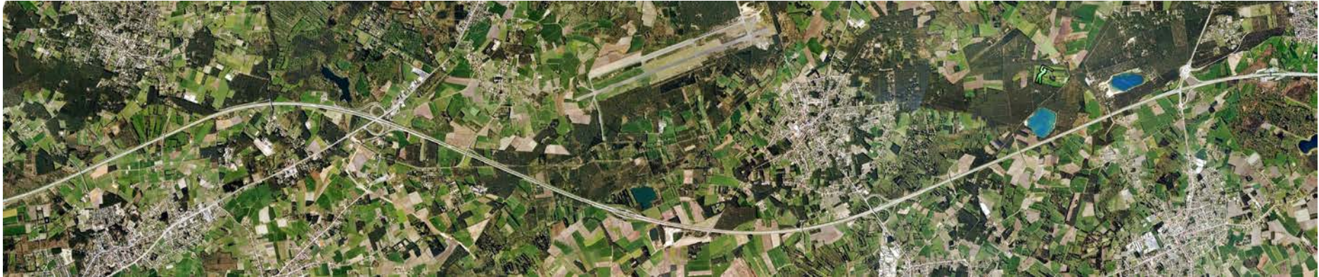
Figuur 31: E3 secties in de Kempen. Opeenvolging bochten verbonden door clotoïden of overgangsbochten. (Bron: Google Earth®)
