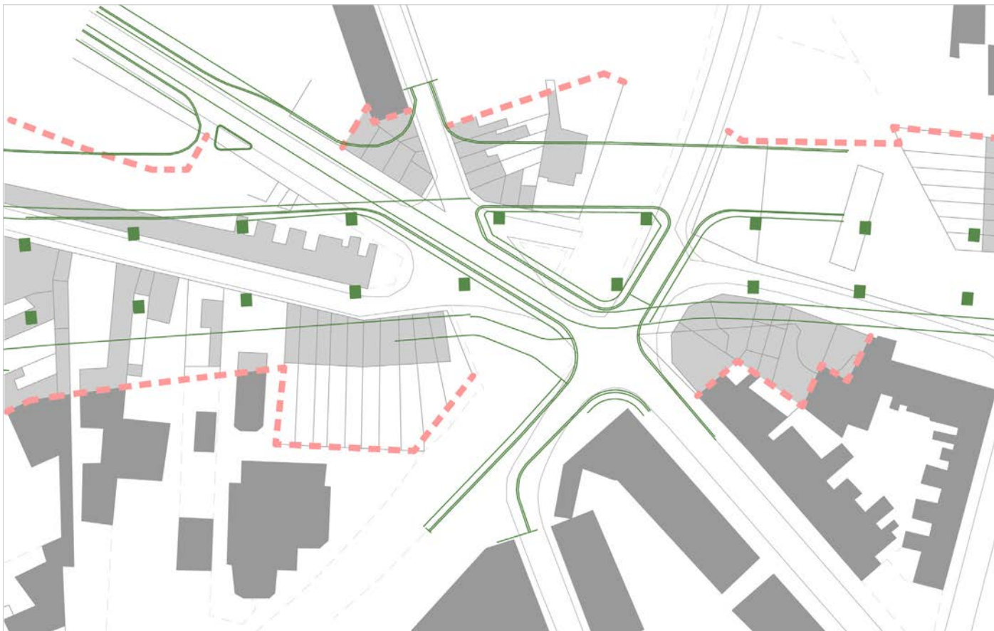
Figuur T-D 11: Herinrichting van het wegenpatroon door de plaatsing van het ingenieursobject. De rode stippelijn stellen de onteigeningsgrenzen voor. (Bron: eigen bewerking op basis van: Onteigeningsplannen Gentbrugge en Stadsarchief Gent 'Zwarte Doos', reeks GAGB, volgnr. 461, Liggingsplan van Kruispunt onder Viaduct, Gentbrugge, 1965 en eigen bewerking.)
