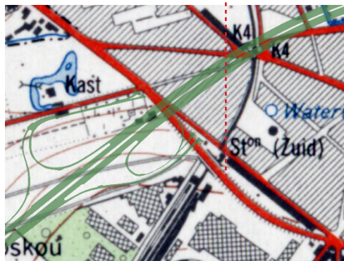
Figuur T-D 10: Modernisering van de Ringspoorweg te Gentbrugge. Op het rechter situeringsplan zien we het viaduct aan het Arsenaal dat diende gesloopt te worden. (Bron: Stadsarchief Gent 'Zwarte Doos', reeks GAGB, volgnr. 463, NMBS, Modernisering van de Lijn 59, Gentbrugge, 10 september 1964.)
