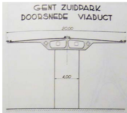
Figuur T-R 15: Technische snede viaduct Gent-Zuid. (Bron: CASIER J., "De E3-autoweg in de provincies Oost- en West-vlaanderen." in E-STRIDE, Oost- en West-Vlaanderen en de E3 , Jaargang 2, nr. 1, maart 1966, blz. 1-52.)
